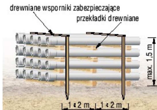
Rys. Składowanie rur na placu budowy
