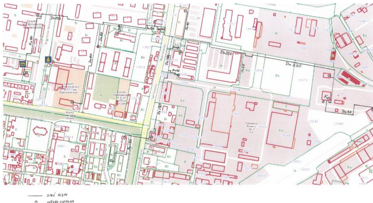
Rysunek 18 Przebieg sieci ciepłowniczej wraz z węzłami ciepłowniczymi, należącej do Rawickiej Spółdzielni Mieszkaniowej.
